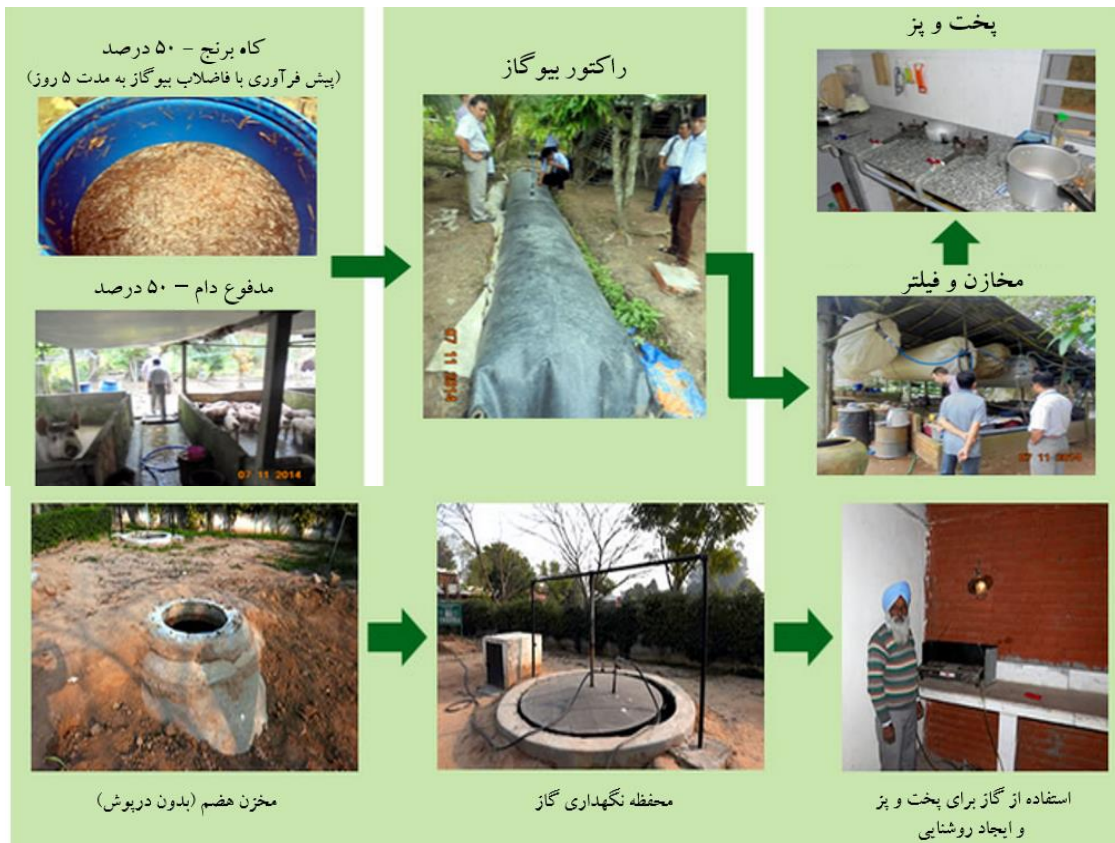
شکل ۷- نمونه‌هایی از فرآیند تولید بیوگاز از کاه و کلش برنج در مقیاس روستایی
