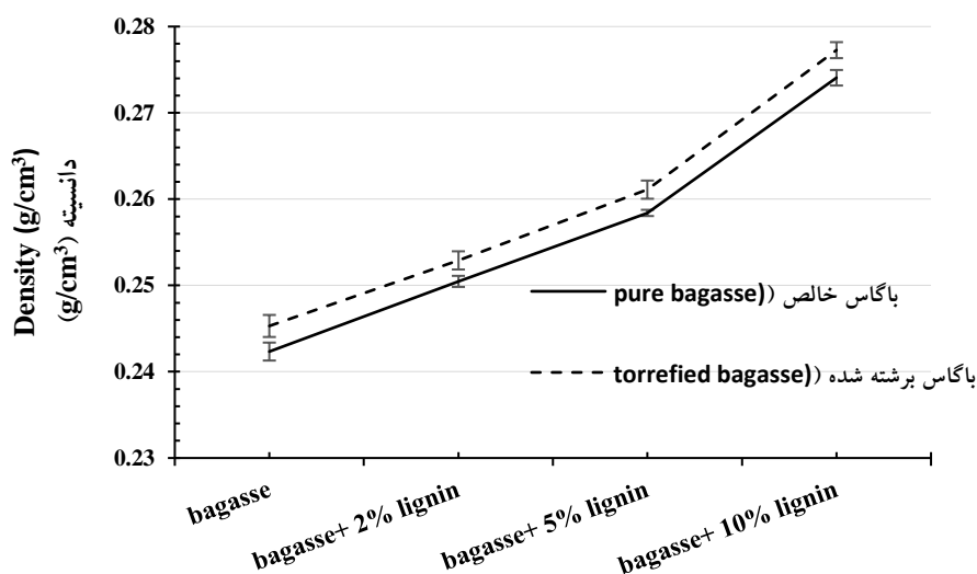
شکل ۲- تأثیر فرایند برشته‌سازی و لیگنین بر دانسیته بریکت‌های سوختی
