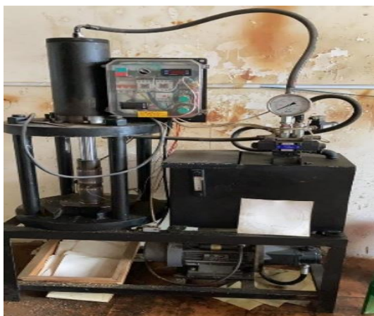
شکل ۱- دستگاه دست ساز ساخت بریکت های سوختی (دانشگاه علوم کشاورزی و منابع طبیعی گرگان)
