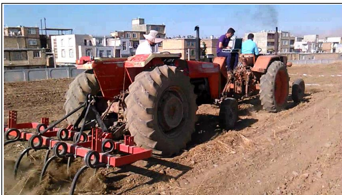
شکل ۱- اندازه‌گیری مقاومت کششی با استفاده از روش دو تراکتوری و حسگر بار مالبندی
