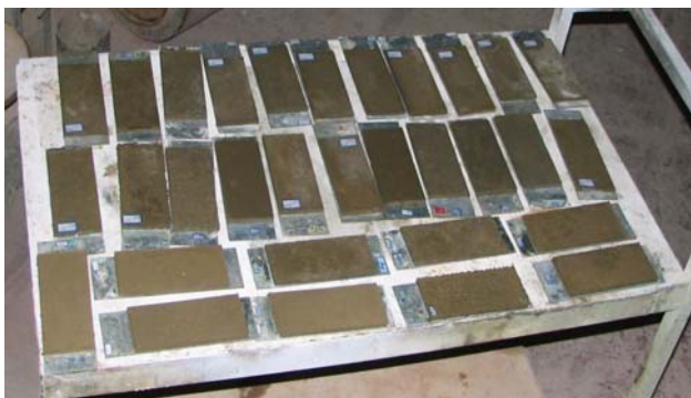
شکل ۳- ورق های سیمانی تولید شده در آزمایشگاه
