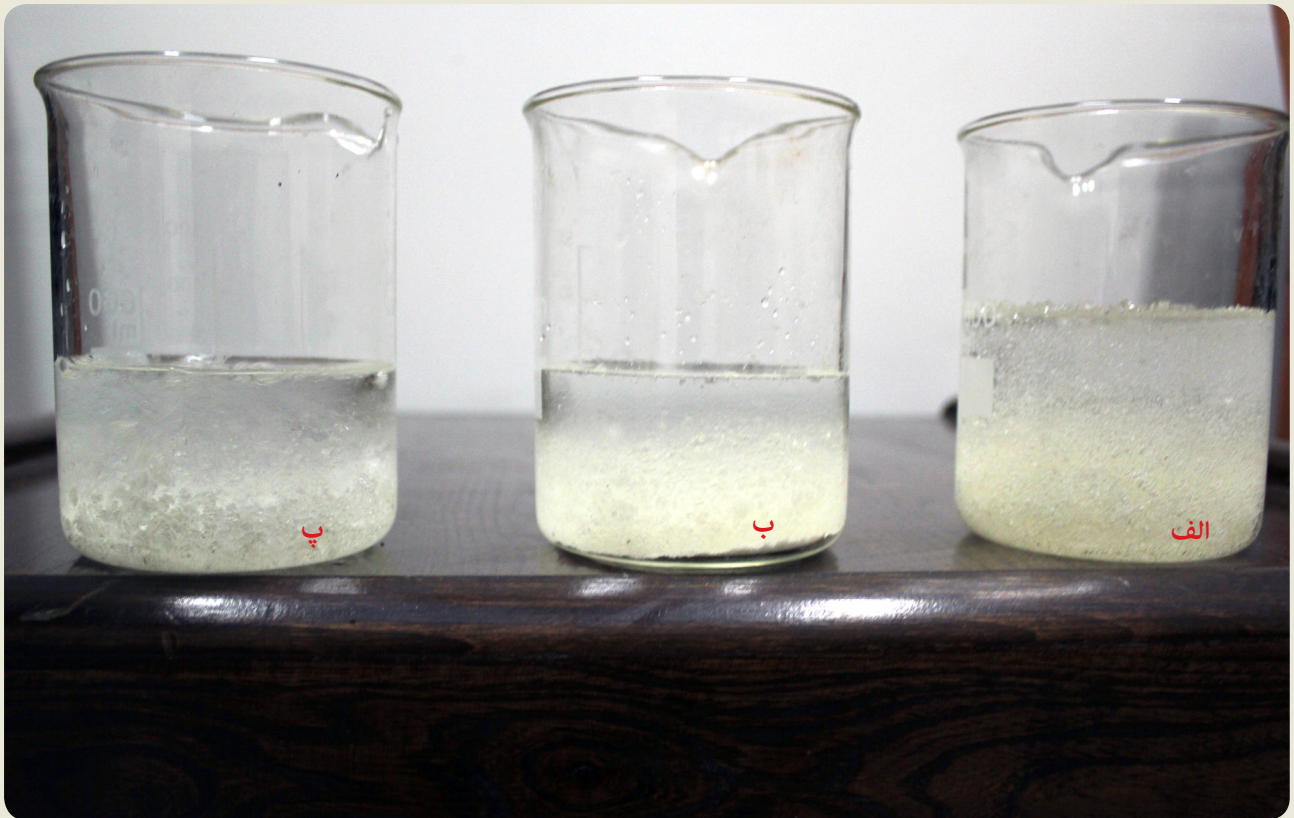
شکل ۳- ظرف سمت راست (الف) پلیمر با ۲۰۰ میلی لیتر آب مقطر، ظرف وسط (ب) پلیمر با ۲۰۰ میلی لیتر آب حاوی ۰/۵ درصد نمک و ظرف سمت چپ (پ) پلیمر با ۲۰۰ میلی لیتر آب حاوی ۰/۹ درصد نمک (افزایش غلظت نمک در این لیوان سبب شد که جذب آب به کمترین حد برسد و مقدار آب آزاد افزایش یابد).
