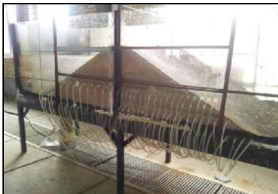
شکل ۳- تصویر مدل آزمایشگاهی سد خاکی و پیژومترهای نصب شده در بدنه مدل (عکس از پایین دست)
