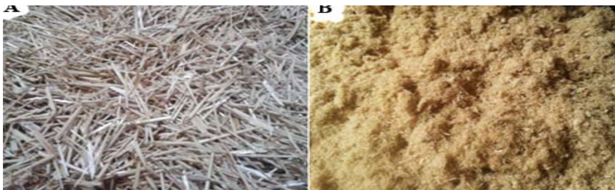
شکل ۱- ساقه‌های گندم تکه تکه شده (A) و الیاف کاه گندم تهیه شده (B)
