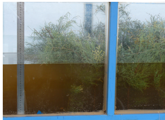
شکل ۲- قرارگیری گیاه گز در فلوم آزمایشگاهی با آرایش و تراکم طبیعی
