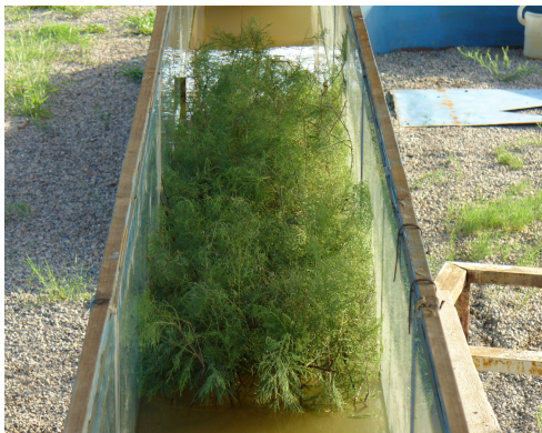
شکل ۲- قرارگیری گیاه گز در فلوم آزمایشگاهی با آرایش و تراکم طبیعی
