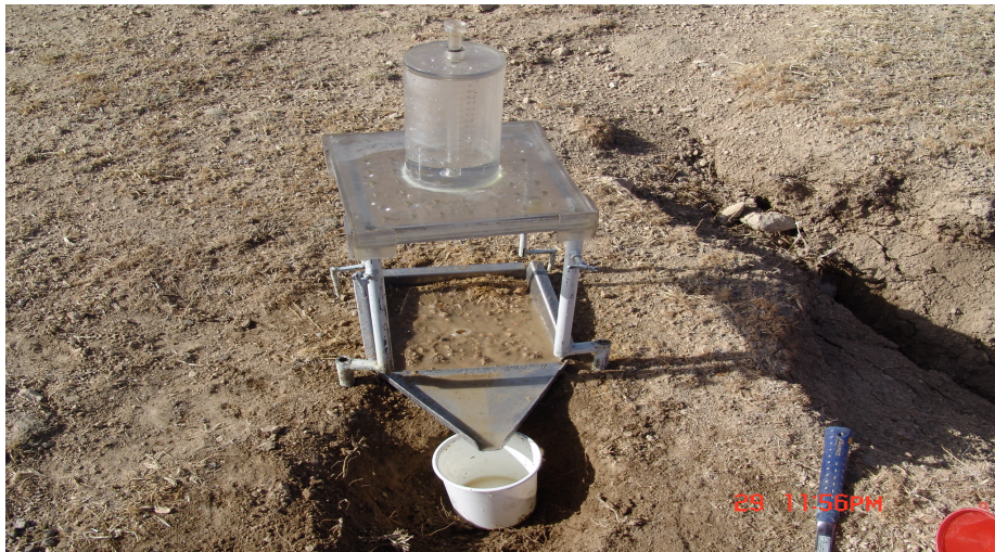
شکل ۱- تصویر دستگاه باران‌ساز کوچک و اجزای تشکیل‌دهنده آن
