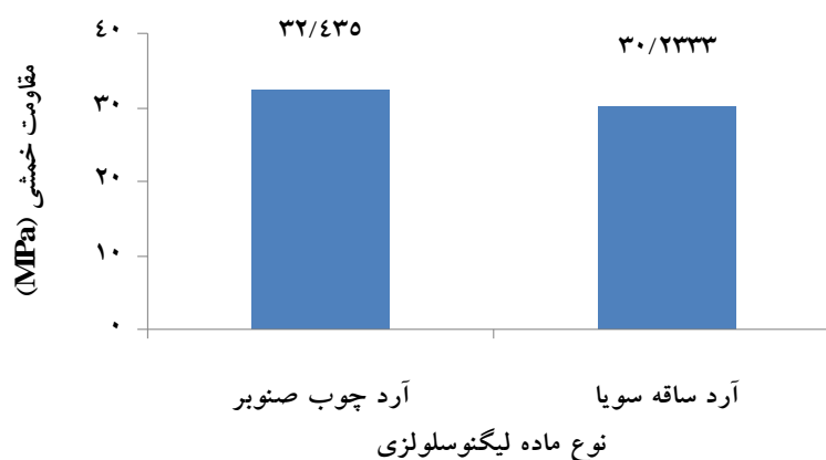
شکل ۷- اثر مستقل ماده لیگنوسلولزی بر مقاومت خمشی
