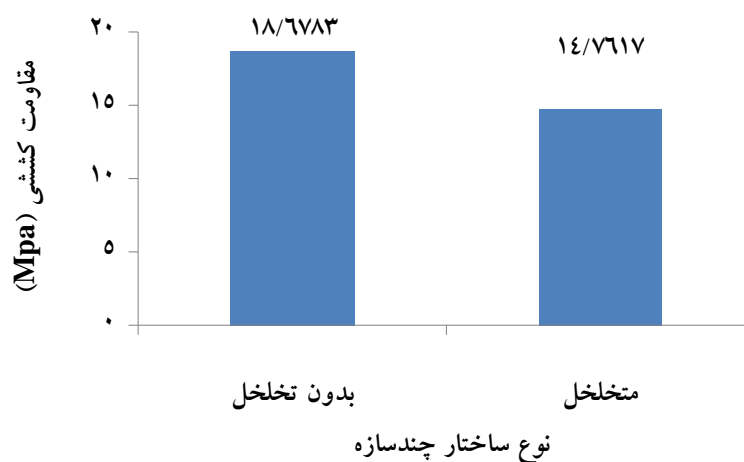
شکل ۱۱- اثر مستقل ساختار چند سازه بر مقاومت کششی
