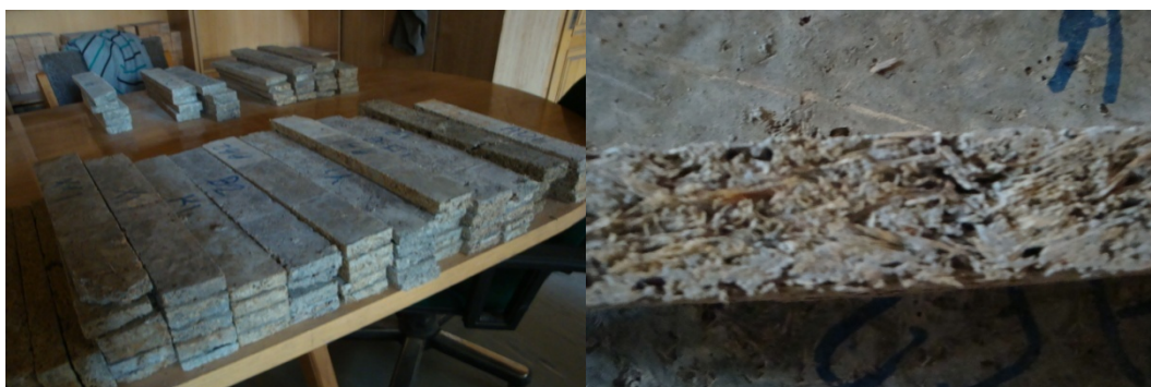
شکل ۴- نمونه‌های چوب سیمان ساخته شده و به ابعاد مناسب بریده شده
