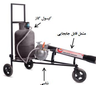
شکل ۱- ردیف کار نئوماتیک در حال کاشت پنبه (سمت راست)، شعله افکن با مشعل قابل جابجایی (وسط) و کنترل علف‌های هرز با شعله‌افکن در مزرعه آزمایشی (سمت چپ)
