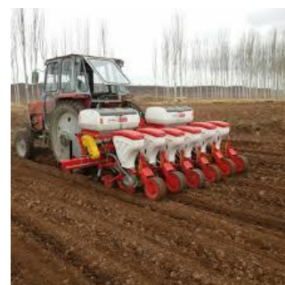
شکل ۱- ردیف کار نئوماتیک در حال کاشت پنبه (سمت راست)، شعله افکن با مشعل قابل جابجایی (وسط) و کنترل علف‌های هرز با شعله‌افکن در مزرعه آزمایشی (سمت چپ)
