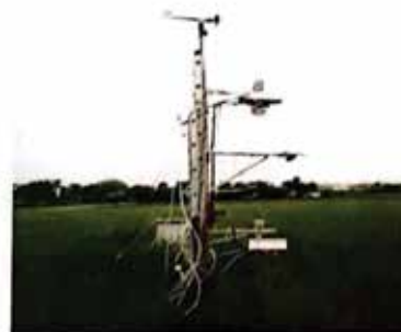
شکل ۱۵- اندازه گیری نسبت برون، تبخیرتوق واقعی و متغیرهای هواشناسی برای گندم ( Triticum aestivum L.) در مزرعه آزمایشی دانشگاه کشاورزی و فناوری توکیو، ژاپن. ناهش خالص خورشی در ارتفاع دو تا چهار متر، حسگرهای خشک و تر برای اندازه گیری اختلاف فشار بخار و دما در دو ارتفاع ۵/۵ تا ۳ و ۲/۵ متر اندازه گیری شدند. مقدار واکنش ۲۵۰ متر محاسبه و در نظر گرفته شد (Attarod, 2005; Attarod et al., 2009)
