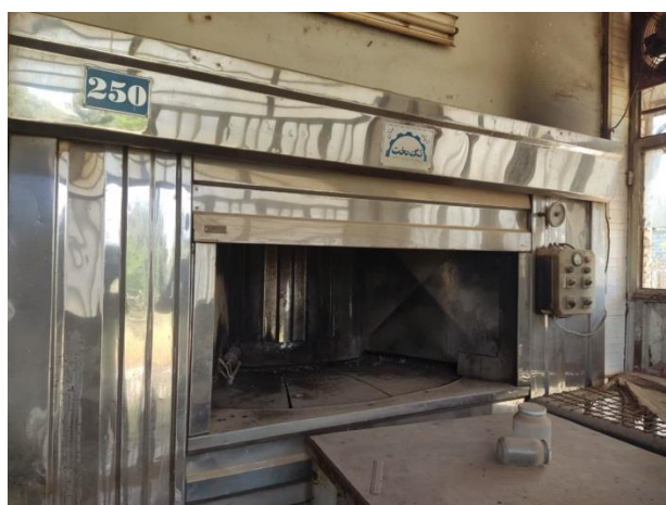
شکل ۲- دستگاه پخت ماشینی دوار با عمر بیش از ۲۰ سال برای تولید نان تافتون در شهرستان دزفول
