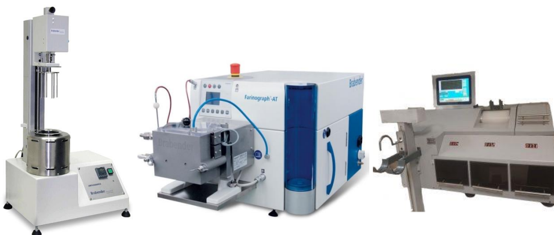
شکل ۸- دستگاه‌های اکستنسوگراف (راست)، فارینوگراف (وسط) و آمیلوگراف (چپ) برای بررسی کیفیت آرد
