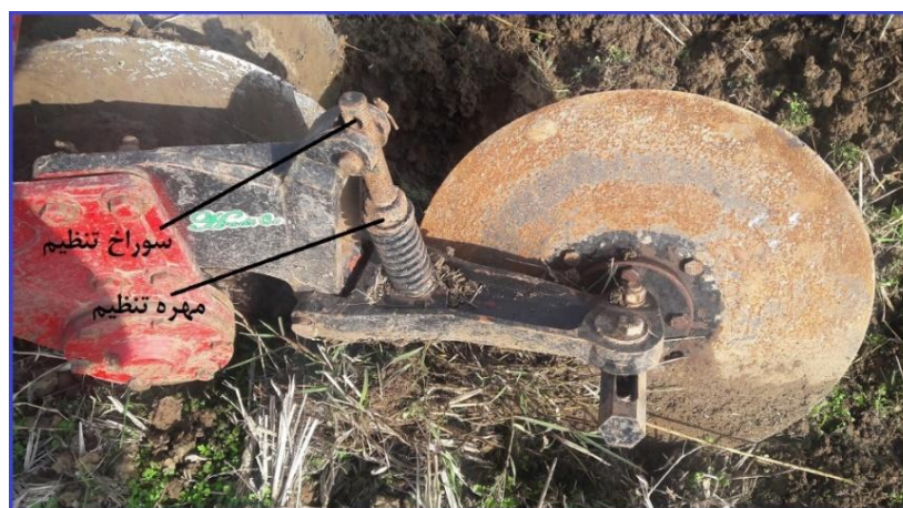
شکل ۶- تنظیم عمق شخم در گاواهن دیسکی دوار
