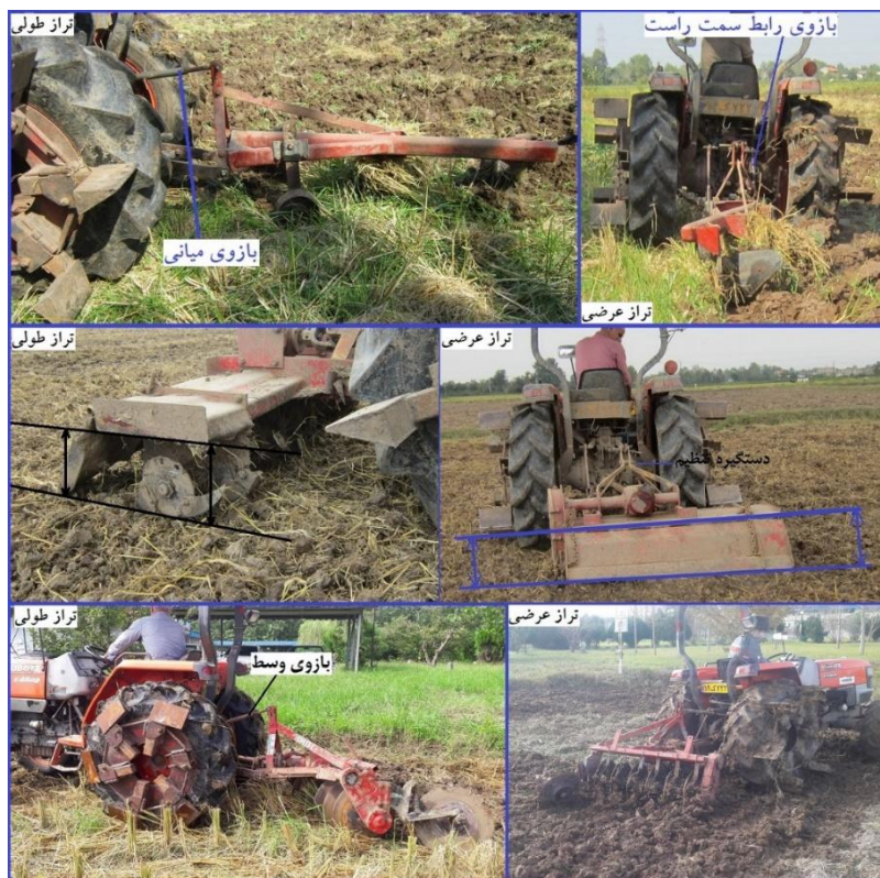
شکل ۲- کنترل و تراز کردن ماشین‌های خاک‌ورزی تراکتوری
