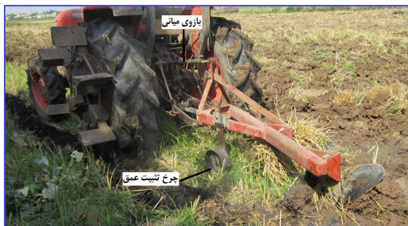
شکل ۳- بازوی وسط و چرخ میزان (چرخ تثبیت عمق)
