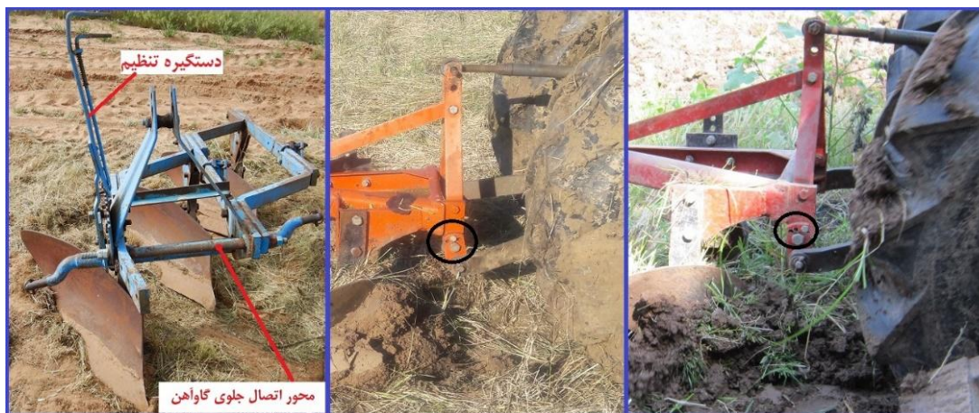
شکل ۷- تنظیم عرض کار در گاواهن برگردان‌دار
