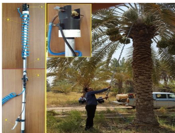
شکل ۱- دستگاه شوینده تلسکوپی با قابلیت تغییر ارتفاع نازل و زاویه پاشش آب/ محلول Figure 1- A telescopic lance with adjustable nozzle height and spray angle
