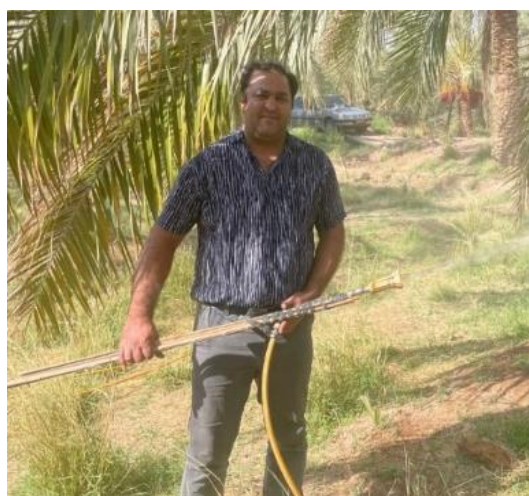
شکل ۲- لانس معمولی مورد استفاده در شستشوی خوشهٔ خرما Figure 2- A conventional lance for washing date clusters
