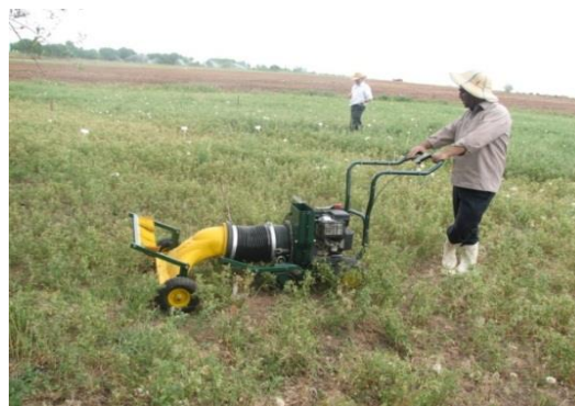
شکل ۲: دستگاه جمع‌آوری آفت سرخ‌طومی برگ‌یونجه هنگام کار در مزرعه (راست)، نمونه‌ای از آفات جمع‌آوری شده اثر سرعت پیشروی بر درصد جمع‌آوری لارو سن ۳، لاروسن ۴، حشره کامل و بذر علف‌های هرز (چپ)
