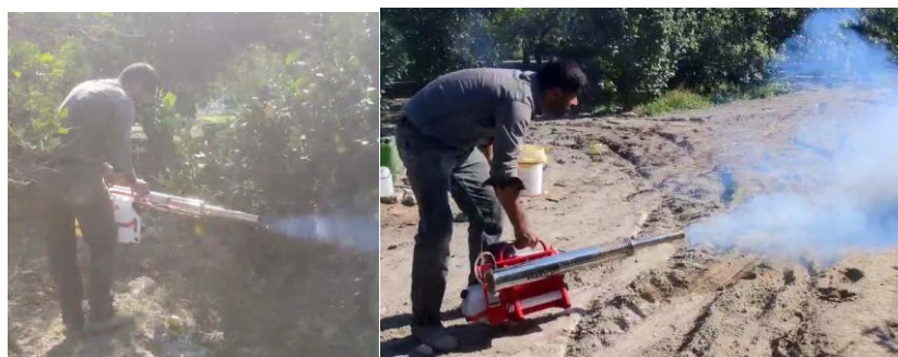
شکل ۱: دستگاه سم پاش فوگر و اجرای سم پاشی در باغ پرتقال
