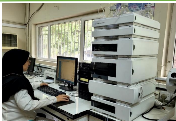
شکل ۳: تزریق نمونه به دستگاه LC/MS-MS
