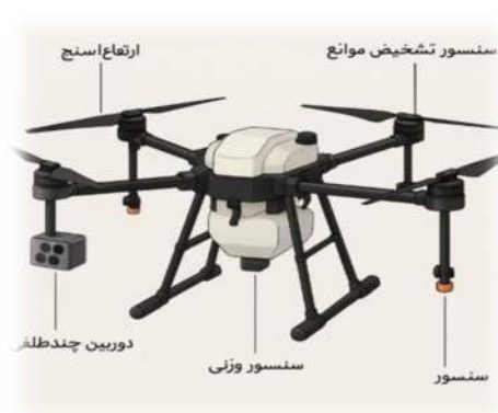
شکل ۱: نحوه قرارگیری سنسورها بر روی پهپاد و چند سنسور مورد استفاده
