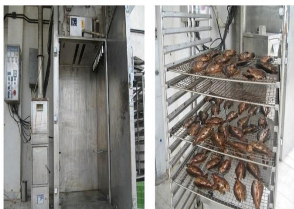
شکل ۴. دستگاه دودی آتموس و ماهیان چیده شده روی واگن آن
