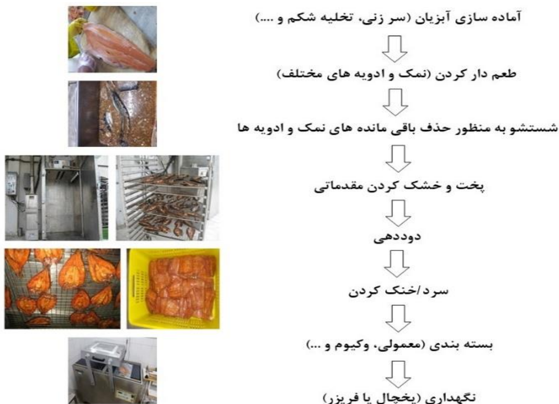
شکل ۱. مراحل مختلف تولید آبزیان دودی شده به روش گرم صنعتی
