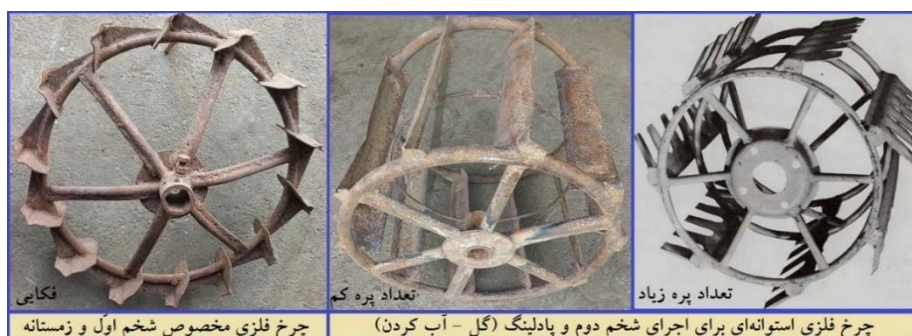
شکل ۱- انواع چرخ فلزی (اصلی)
