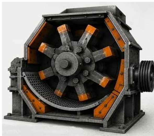
شکل ۴. نمایی از فرارگیری چکش‌ها در آسیاب (نقطه حساس سایش)
