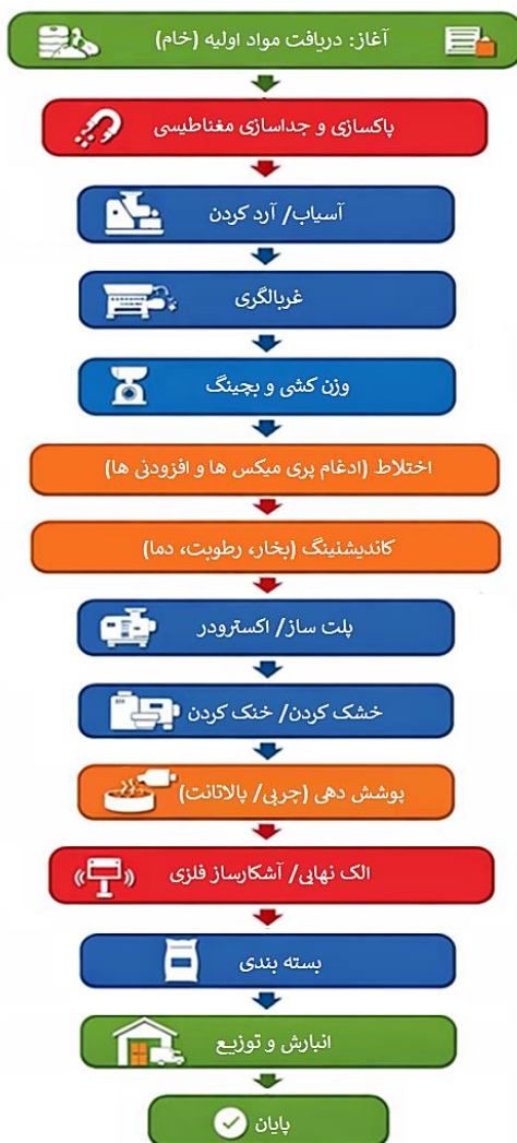
شکل ۱. فلوچارت جریان کلی تولید خوراک خشک آبزیان (برگرفته از Hasting & Higgs, 1980)
