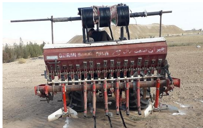
شکل ۲- اصلاح خطی کار برای دو حالت بستر با عرض ۳۰ سانتی متر (سمت چپ) و بستر با عرض ۸۰ تا ۹۰ سانتی متر (سمت راست)
