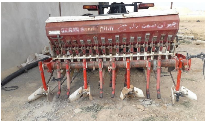
شکل ۲- اصلاح خطی کار برای دو حالت بستر با عرض ۳۰ سانتی متر (سمت چپ) و بستر با عرض ۸۰ تا ۹۰ سانتی متر (سمت راست)
