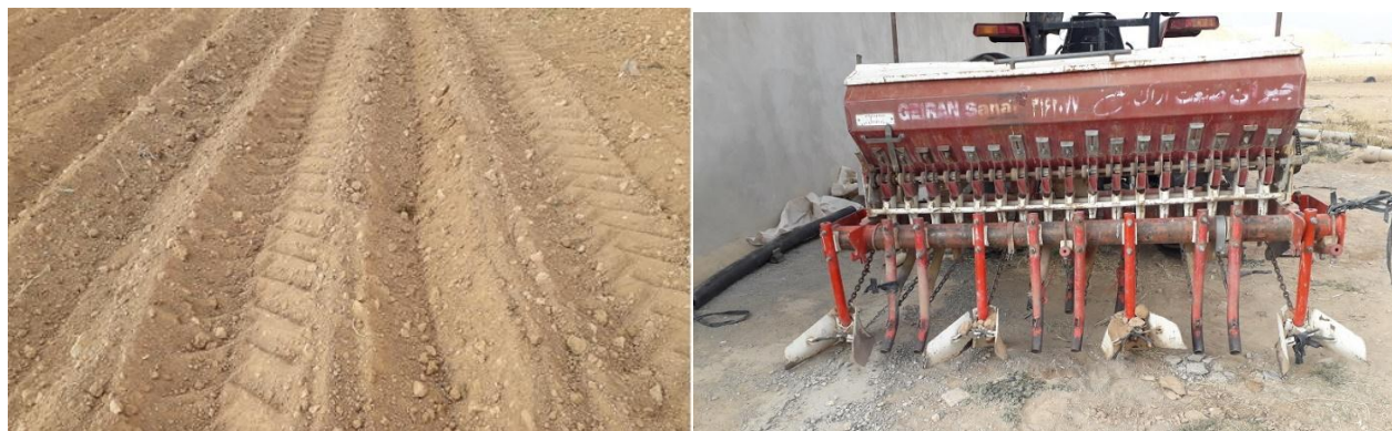
شکل ۱- اصلاح خطی کار برای حالت بستر بلند با عرض ۳۰ سانتی‌متر (سمت راست) و شکل بستر بلند با عرض ۳۰ سانتی‌متر (سمت چپ)
