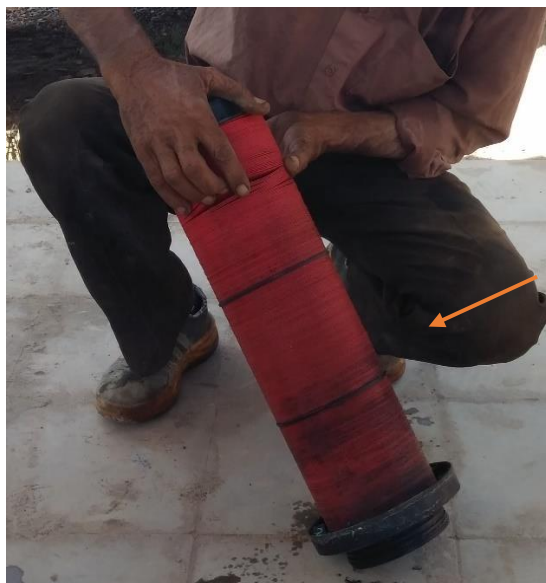
شکل ۵- ورود ذرات شن به داخل فیلترهای ثانویه (دیسکی) قرار گرفته بعد از فیلتر شن
