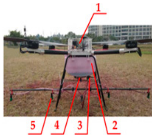
شکل ۳. پهپادسمپاش میزان - متغیر (۱: سامانه بینایی و کنترل گر مرکزی، ۲: مخزن، ۳: دبی‌سنج، ۴: پمپ دیافراگمی، ۵: افشانک میزان - متغیر) (ون و همکاران، ۲۰۱۸).
