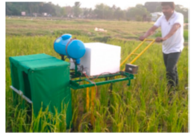
شکل ۱. سمپاش زمینی حسگر - مبنا (تواری و همکاران، ۲۰۲۰)
