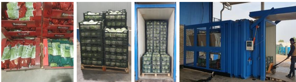
شکل ۵- پیش‌خنک‌کردن کاهو تحت خلأ در واحد صادرات کاهو در استان خوزستان (الف و ب) و قراردادن بسته‌های کاهوی آیسبرگ (پ) و رومن (ت) در انبار سرد
