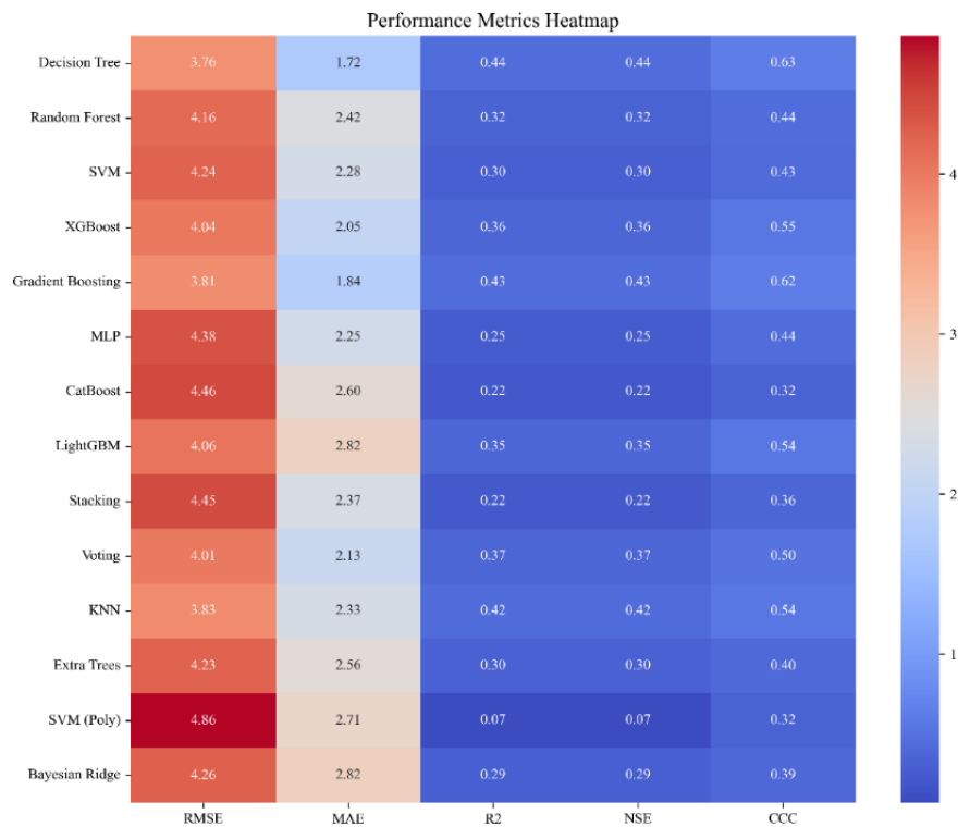
شکل ۴ - نقشه حرارتی مقایسه عملکرد مدل‌های یادگیری ماشین در پیش‌بینی شاخص آب‌گریزی خاک (WDPT) پس از آتش‌سوزی بر اساس معیارهای RMSE, MAE, R 2 , NSE و CCC.
