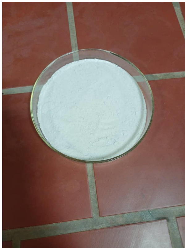
شکل ۳- پودر سفیدرنگ حاوی سیلیس استخراج شده از پوسته برنج
