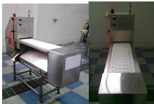
شکل ۱. نماهای روبه‌رو و جانبی دستگاه هسته‌گیر سوزنی- فنجانى
