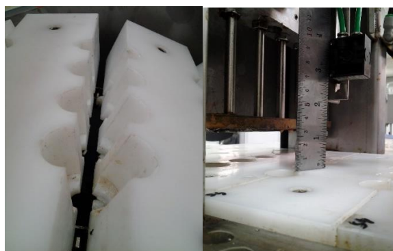
شکل ۲. راست) قرارگیری فنجانک‌ها و سوزن‌ها در موقعیت هسته‌گیری و چپ) مکانیزم بازشدن فنجانک‌ها در انتهای دستگاه.
