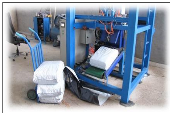
شکل ۷- تهیه سیلاژ محصول فرعی پسته در کیسه‌های سه‌لایه با دستگاه دارای فشار (راست)
