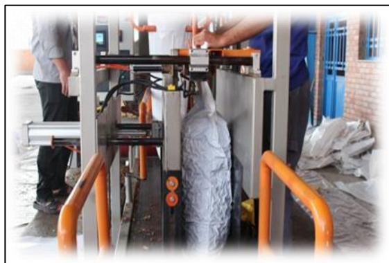
شکل ۷- تهیه سیلاژ محصول فرعی پسته در کیسه‌های سه‌لایه با دستگاه دارای فشار (راست)
