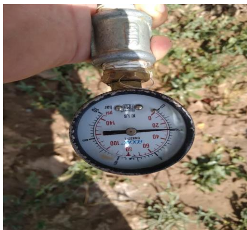
شکل ۲- اندازه گیری فشار در انتهای لوله لترال
