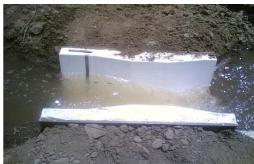
شکل ۲- اندازه گیری دبی آب آبیاری به کمک کنتور حجمی (راست) و فلوم WSC (چپ) به ترتیب در سامانه های آبیاری قطره ای نواری (تیپ) و سطحی
