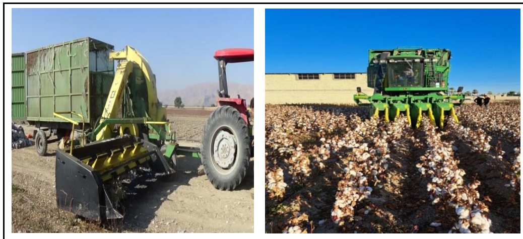
شکل ۱- ماشین‌های و ش چین (سمت راست) و غوزه چین (سمت چپ) مورد استفاده در آزمایش
