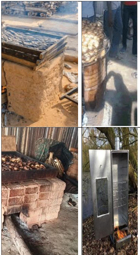
شکل ۲. کوره‌های سنتی برای دودی کردن آبزیان: A؛ کوره فلزی استوانه‌ای، B؛ کوره گلی، C؛ فر فلزی مستطیل، D؛ فر چورکور.
