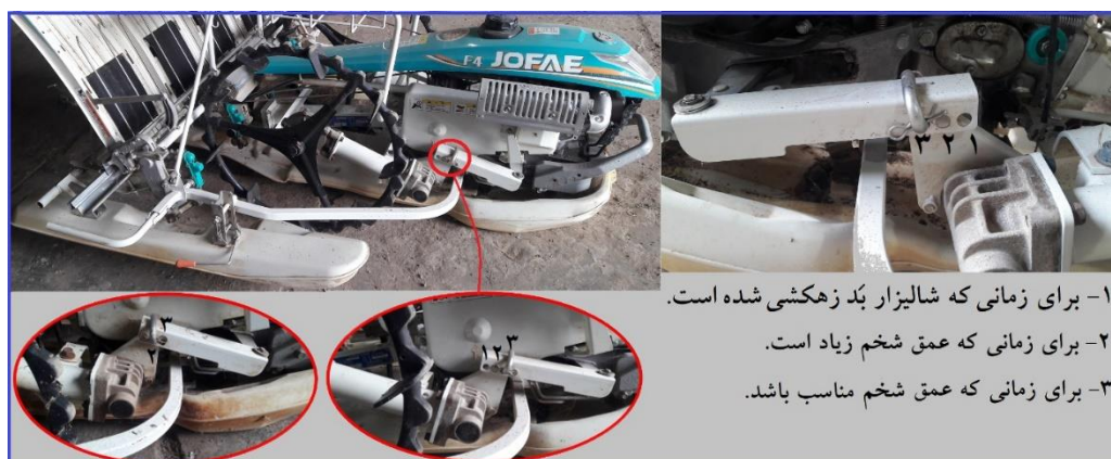
شکل ۹- تنظیم ارتفاع چرخ‌های محرک با تغییر موقعیت سوراخ رابط تنظیم چرخ (اصلی)
