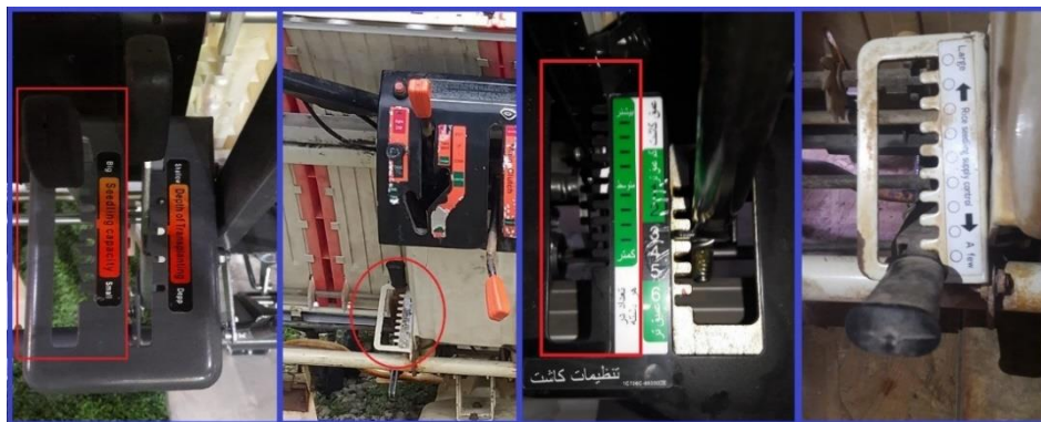
شکل ۳- اهرم کنترل طول نشابررداری در انواع نشاکار (اصلی)
