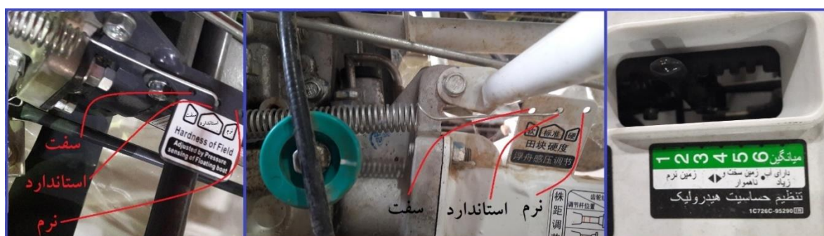
شکل ۸- تنظیم اهرم کنترل حساسیت هیدرولیک در انواع نشاکار (اصلی)
