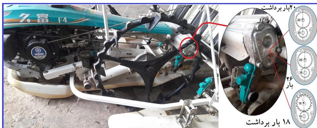
شکل ۷- تنظیم تعداد دفعات تغذیه افقی (اصلی)
