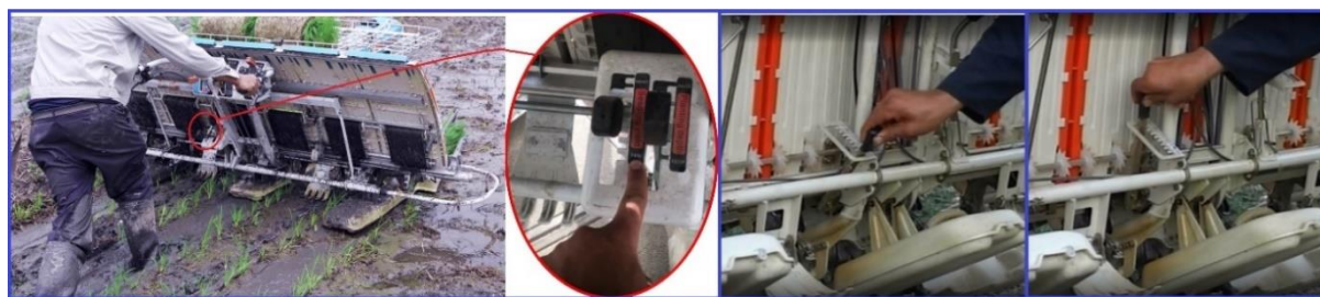
شکل ۴- تنظیم اهرم کنترل طول نشابررداری (ایترنت)
