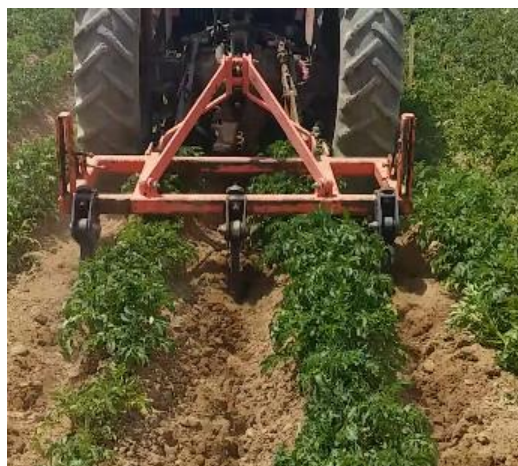
شکل ۴- وضعیت رطوبتی خاک در زمان خاک ورزی بین ردیفی با چیزل پکر
