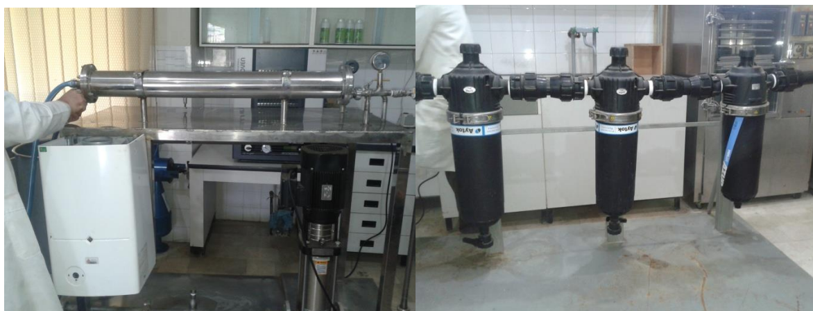
شکل ۳- بخش میکروفیلتراسیون (راست) و اولترافیلتراسیون (چپ) در روش استخراج غشایی
