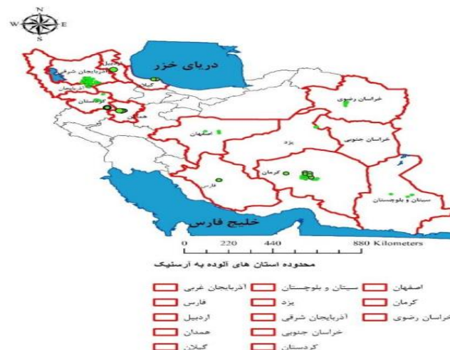
شکل ۵- توزیع نقاطی با آب آلوده به آرسنیک در ایران (دوایر سبز رنگ) به تفکیک استان های آلوده به آرسنیک Figure 5- Distribution of points with arsenic-contaminated water in Iran (green circles) by separating arsenic-contaminated provinces (Khadem.Igdellou and Golchin, 2019)
