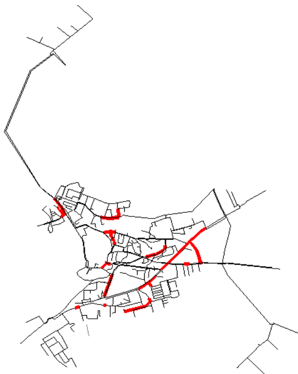
شکل ۱۸ - شبکه کنگاور - موقعیت لوله‌های با افزایش قطر
