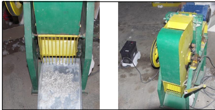
شکل ۱- ماشین جین اره‌ای (سمت راست) و جداسدن بذرها از الیاف پنبه (سمت چپ) Fig. 1- Saw gin machine (right side) and separating seeds from cotton (left side)
