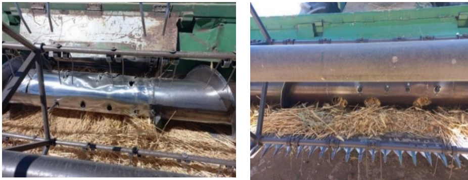
شکل ۴- فرسودگی استوانه ماریپیچی روی واحد جمع‌آوری کمباین
