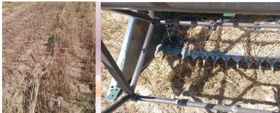
شکل ۲- افت ناشی از شکستگی تیغه و فقدان جداکننده‌ها در واحد جمع‌آوری کمباین
