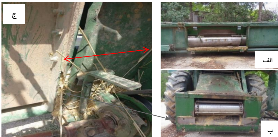
شکل ۳- واحد جمع‌آوری کمباین (الف)، محل اتصال واحد جمع‌آوری کمباین (ب)، عدم درزبندی صحیح محل اتصال واحد جمع‌آوری با بدنه کمباین (ج)
