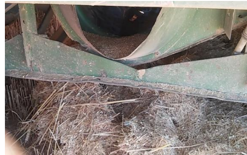
شکل ۱۰- افت ناشی از فرسودگی و عدم درزبندی مناسب دریچه‌های روی بدنه کمباین
