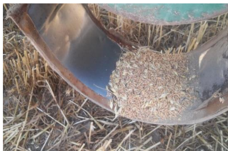
شکل ۸- مخلوط صحیح مواد در بالابر برگشت (الف) و وجود بیش از حد دانه در بالابر برگشت (ب)
