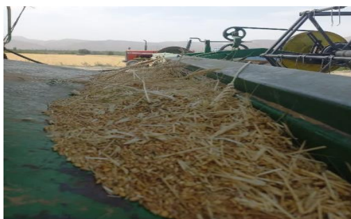
شکل ۱۰- افت ناشی از فرسودگی و عدم درزبندی مناسب دریچه‌های روی بدنه کمباین
