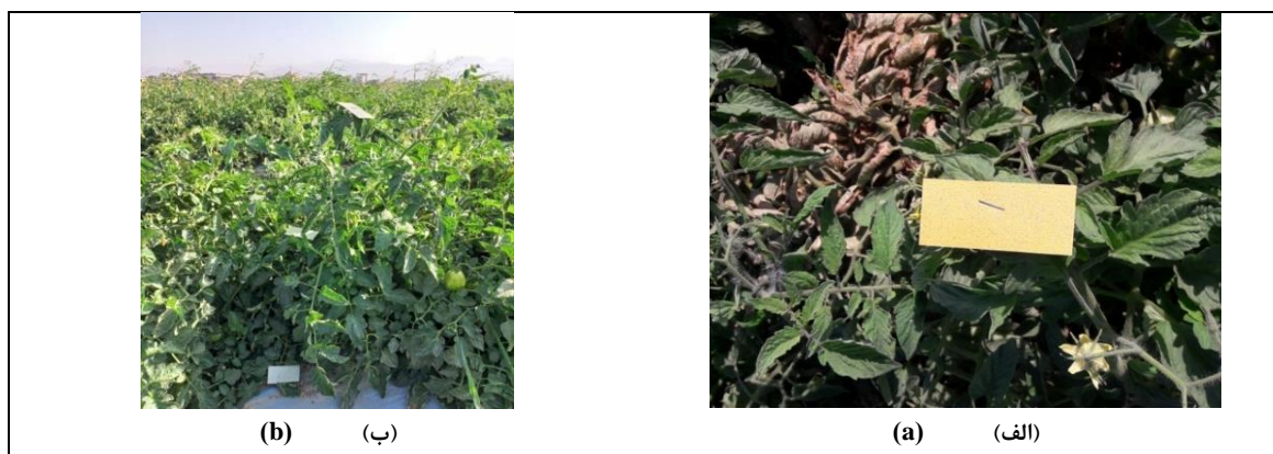
شکل ۲- الف) کارت حساس به منظور تعیین یکنواختی پاشش و ب) تعیین درصد پوشش دهی قطرات در قسمت فوقانی، میانی و تحتانی گیاه
