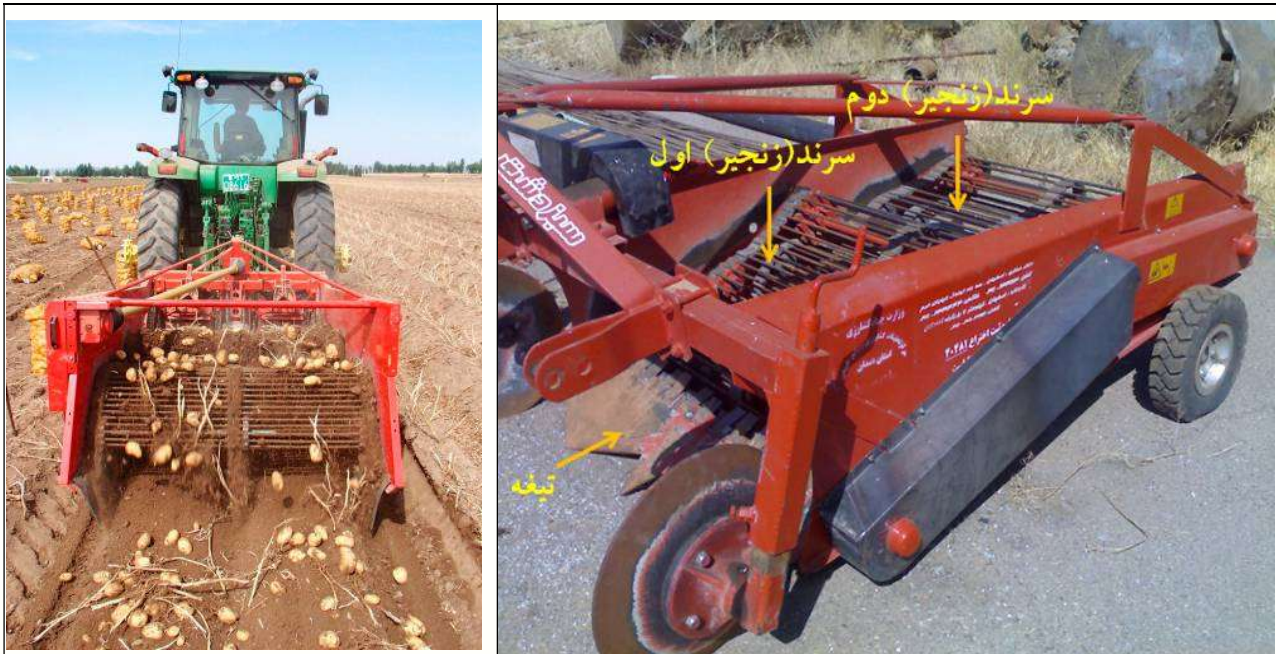
شکل ۱- سیب زمینی کن دو ردیفه با زنجیر نقاله
