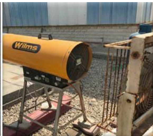
شکل ۵: دستگاه مولد جریان هوای داغ جهت خشک کردن ماهی ساردین و موتو در جزیره قشم
