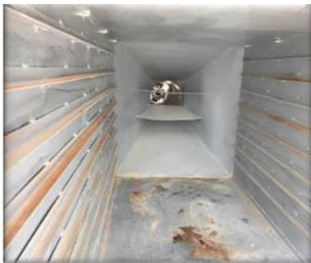
شکل ۵: دستگاه مولد جریان هوای داغ جهت خشک کردن ماهی ساردین و موتو در جزیره قشم
