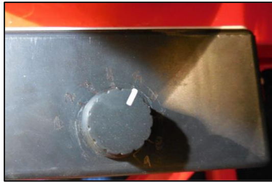
شکل ۴- علامت‌گذاری انجام شده در اطراف ولوم کنترل‌کننده PWM Fig. 4- Marking done around the PWM controller volume
