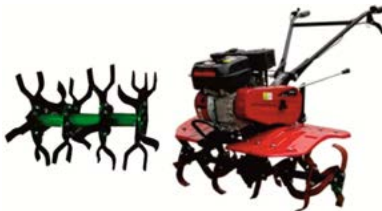
شکل ۱- تعویض تیغه های L شکل با تیغه های عمودی سه شاخه ای
